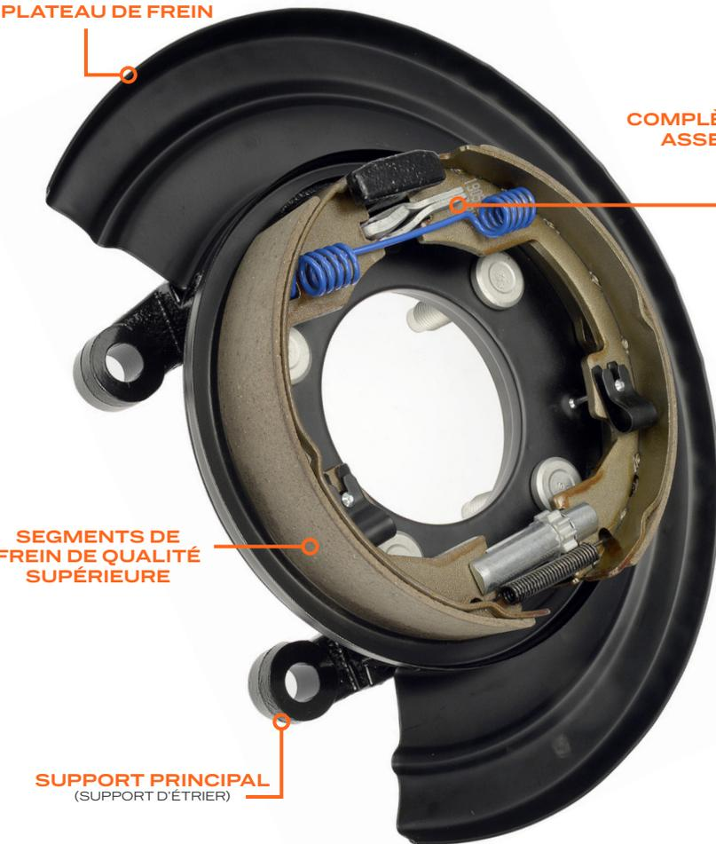
Les réparations de plateau de frein et de frein à main peuvent être longues et imprévisibles lorsque des composants rouillés sont achetés et remplacés individuellement.
